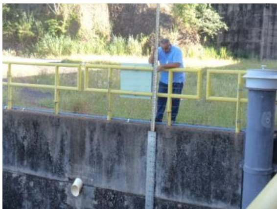
Figura 9 – Leitura da cota da régua de jusante.
